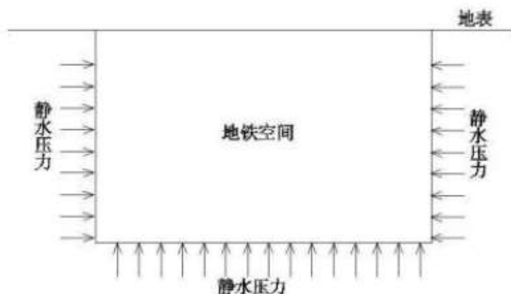
图 5.5.4-1 地铁承受静水压力示意图
