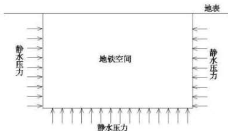
图 5.5.4-1 地铁承受静水压力示意图
