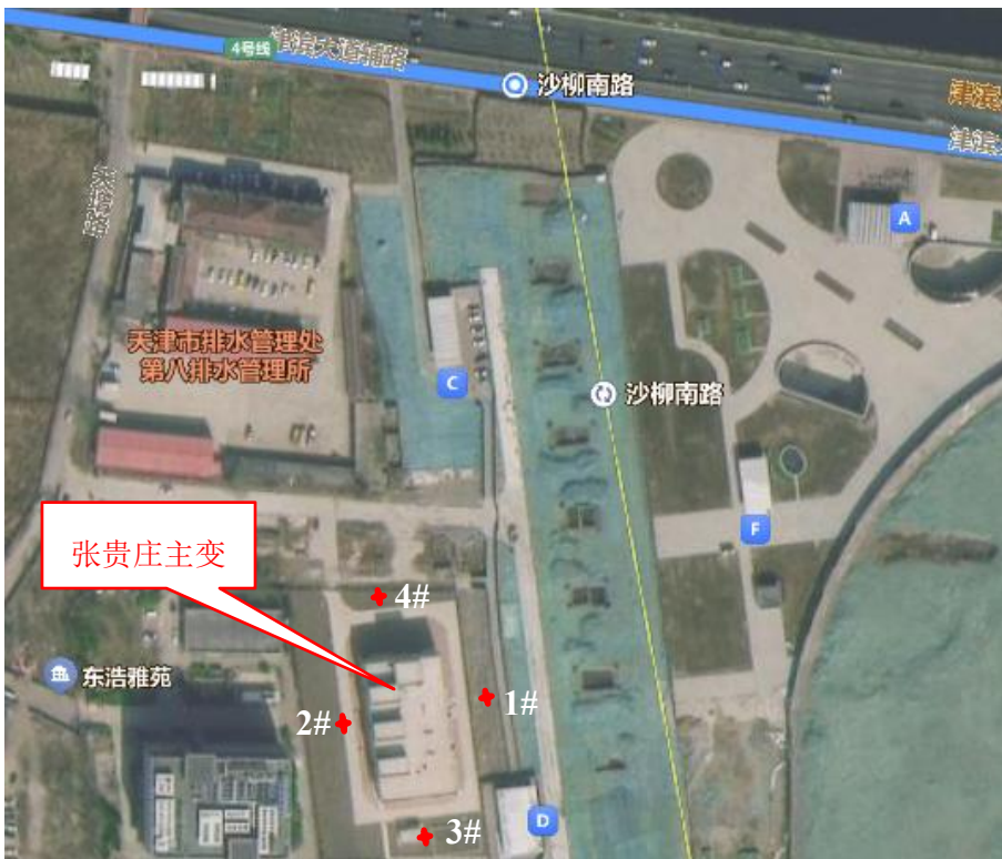
图 5.5-1 张贵庄主变站厂界辐射监测布点示意图
